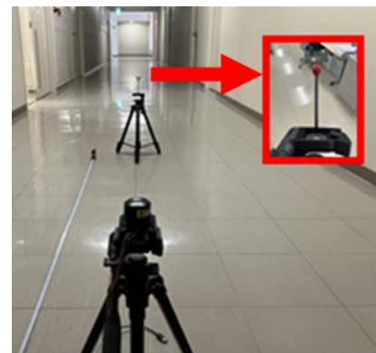
図 5:障害物検知実験の様子 (赤枠はカーボンボール)
