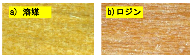
図 6. CLT 表面の拡大写真 a) 溶媒処理、b) ロジン処理
